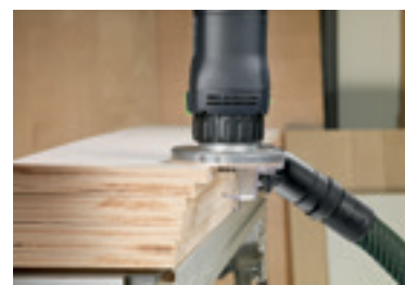
Фрезерование пластмассовой или деревянной кромки.
