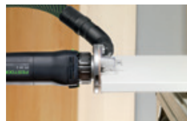
Скругление пластмассовой или деревянной кромки.
