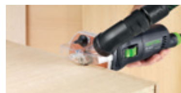
Фрезерование пластмассовой или деревянной кромки заподлицо.
