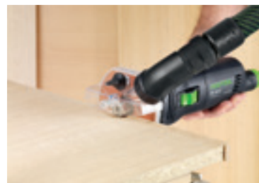
Фрезерование пластмассовой или деревянной кромки заподлицо.
