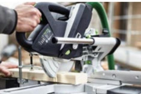
**Хороший обзор линии разметки.** Яркое светодиодное освещение отбрасывает на заготовку глубокую тень от пильного диска, которую можно использовать в качестве линии разметки.
