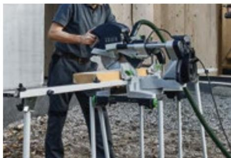
**Точность за один проход:** торцовочная пила с протяжкой KS 120 позволяет торцевать брус и балки толщиной до 88 мм и имеет специальное встроенное положение для торцевания с глубиной реза до 120 мм. Такие продуманные детали, как двухлинейный лазер и малка-угломер гарантируют точные результаты.
