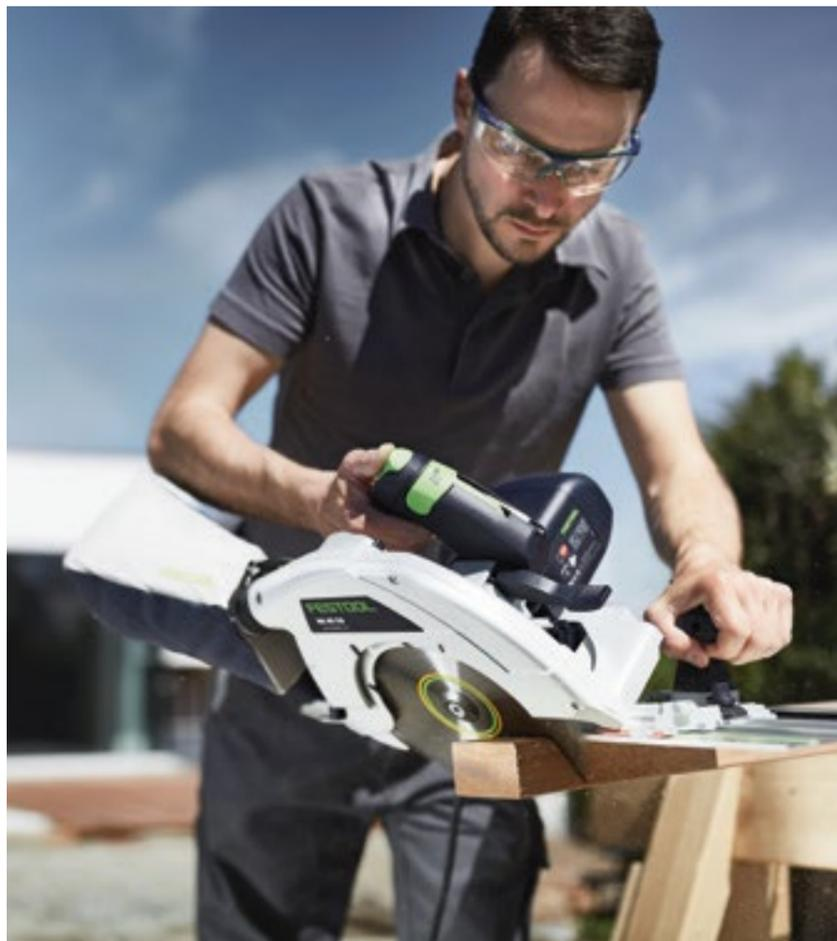
**Мощный** электродвигатель на 2300 Вт с электронным управлением обеспечивает постоянную производительность пиления НК 85.
