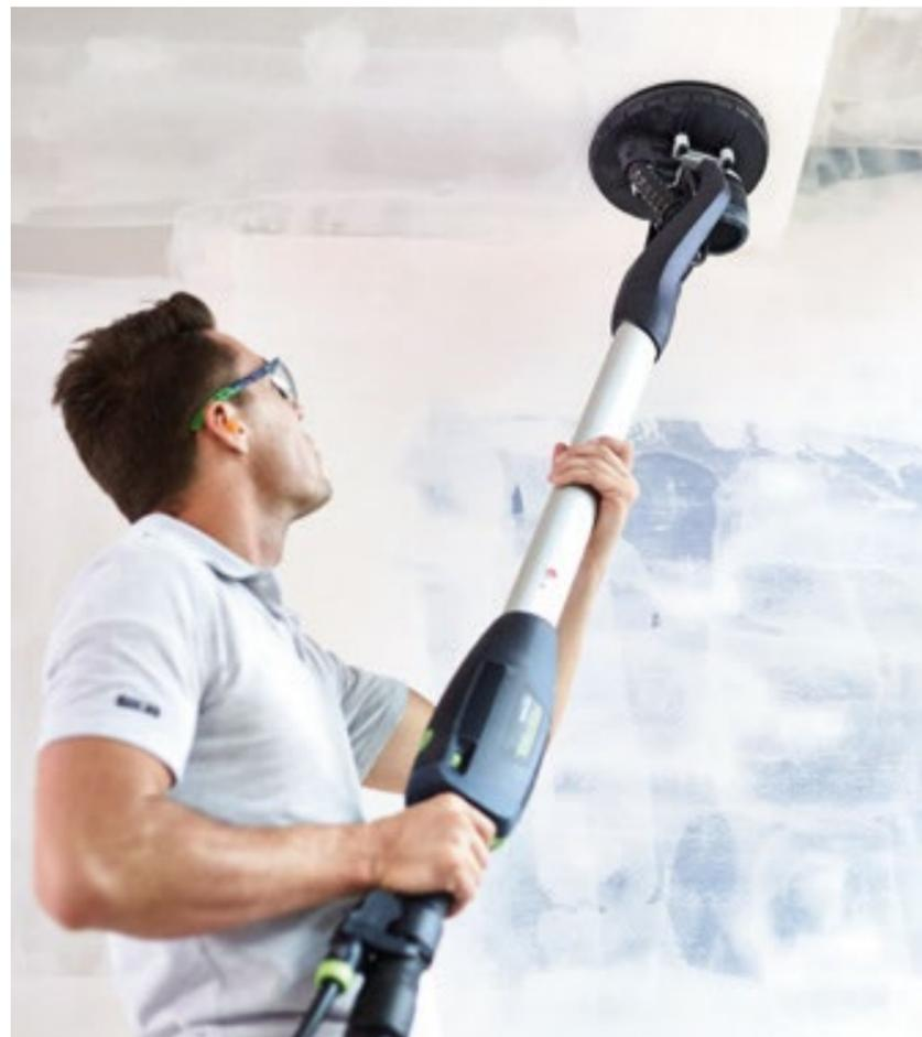
**Никогда ещё сухое строительство не было таким простым делом:** шлифмашина для стен и потолков PLANEX easy не требует ухода благодаря бесщёточному электродвигателю EC-TEC без гибкого вала, а её малый вес облегчает работу. Это касается и стен, и потолков.
