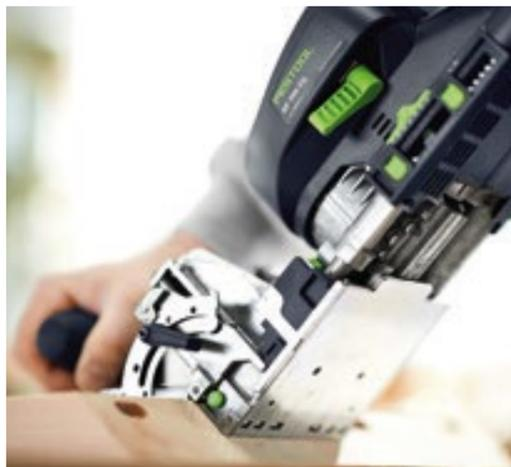
**Быстрые соединения вне мастерской:** даже прочные соединения деталей из массива древесины выполняются с помощью DOMINO XL быстро и точно. Для установки шипов DOMINO размером до 14x140 мм. Мы предлагаем подходящие шипы DOMINO для использования как в помещениях, так и снаружи.
