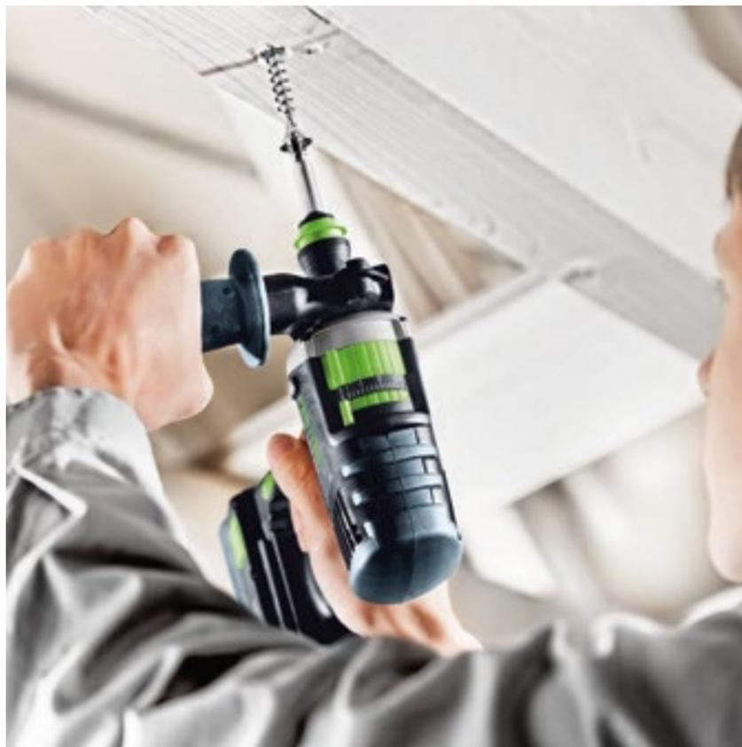
**60 Нм на 1-й скорости!** QUADRIVE DRC легко справляется даже с саморезами 10/12. А при переналадке на PDC с переключением на аксиальный удар – и со сверлением в кирпичной кладке.
