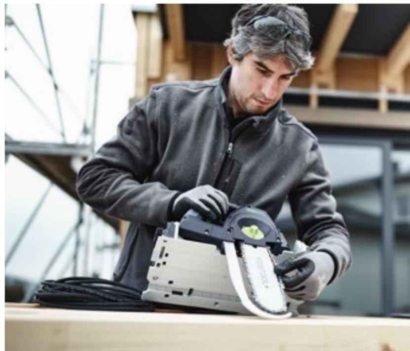
**Универсальное применение:** цепная пила UNIVERS SSU 220 режет все материалы толщиной до 200 мм, применяемые в деревянном строительстве, будь то древесина или изоляционные маты. В комбинации с шиной-направляющей можно выполнять абсолютно прямые и точные торцовые, продольные и косые пропилы без сколов.
