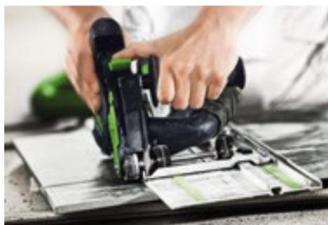
**Точное ведение, чистая работа:** Алмазная отрезная система DSC-AG с шиной-направляющей для точного распила фасадных облицовочных плит – и пылеудаляющий аппарат для безвредных условий труда.
