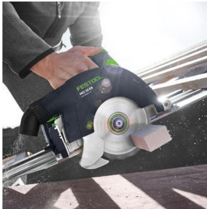
**Повышение мобильности в деревянном строительстве:** аккумуляторная дисковая пила НКС 55 с торцовочной шиной FSK наглядно демонстрирует, что можно сделать современной пилой на крыше.
