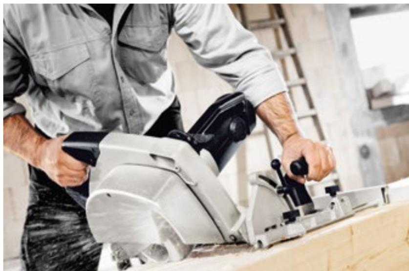
**Снимаем пильный диск и ставим фрезу:** с фрезой для выборки клиновидного паза дисковая пила НК 132 Е без особых усилий превращается в надёжный плотницкий фрезер.
