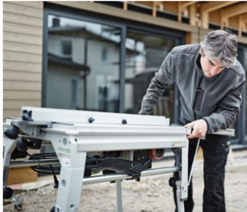
**Простая транспортировка:** лёгкая монтажная дисковая пила PRECISIO CS 70 с продуманными функциями распиливает заготовки толщиной до 70 мм. Несмотря на её габариты она легко перевозится и быстро приводится в рабочее положение.
