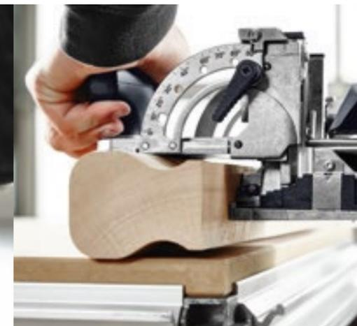
**Экономия времени:** при изготовлении каркасных соединений дюбельным фрезером DOMINO Вы экономите массу времени. Идеально для быстрой и точной установки поручней.
