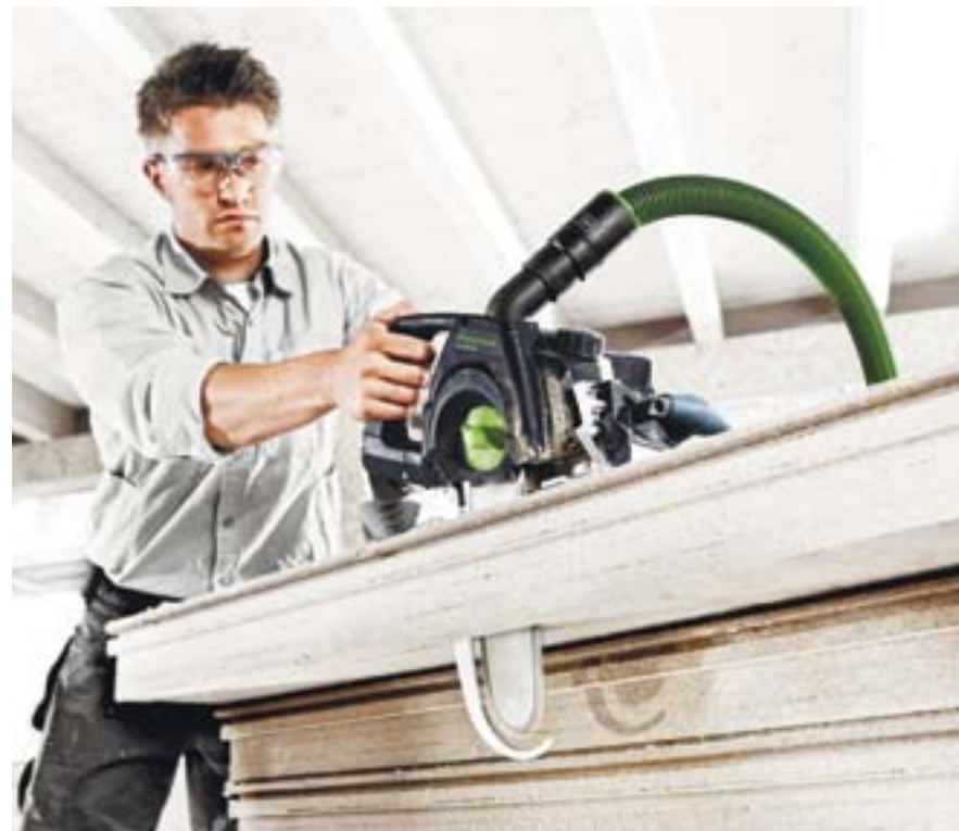
Идеальная точность: цепная пила Univers SSU 200 EB с глубиной реза 200 мм для раскроя различных видов изоляционных материалов.
