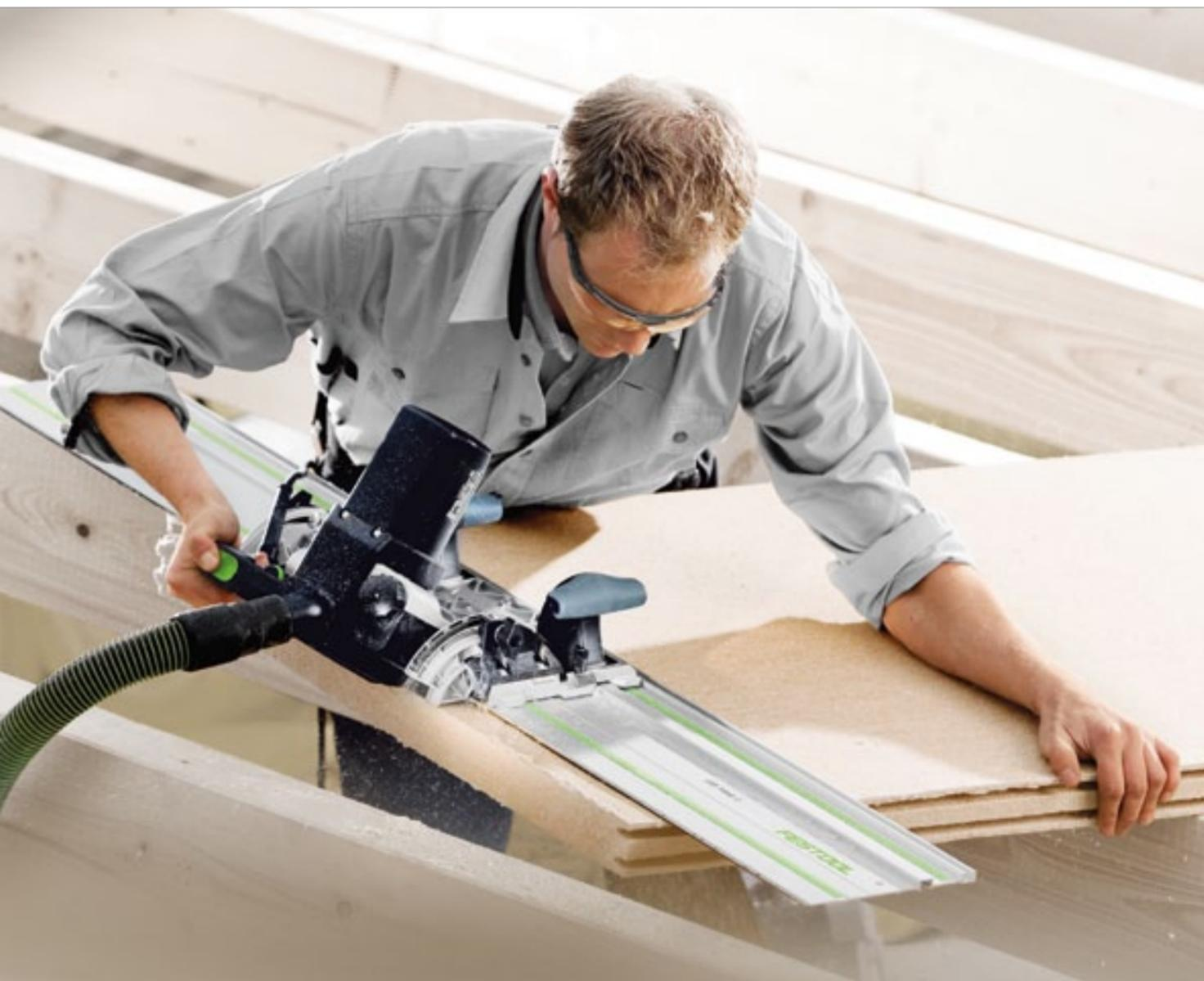
Идеальный вариант для мобильного применения: цепная пила UNIVERS весом всего 6,5 кг с глубиной реза 200 мм в комбинации с шиной-направляющей. Превосходный распил древесины и жёсткой изоляции.
