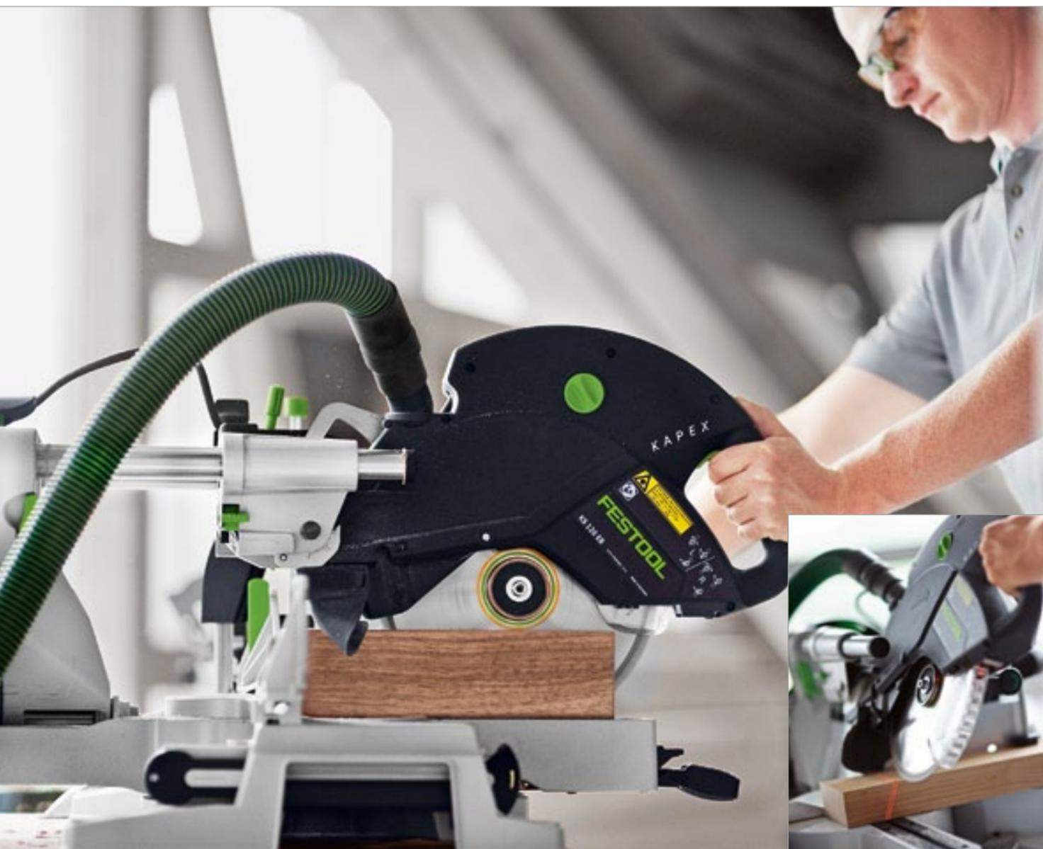
Для качественного пиления без сколов. KS 120 отличается точными резами благодаря системе ведения диска на двух опорах, впечатляющей производительностью пиления в заготовках толщиной до 120 мм и малым весом 21,5 кг.
