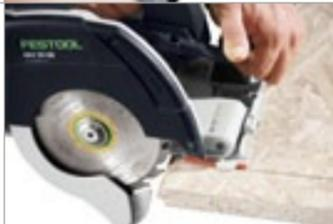
**Направляющий клин для повышения безопасности:** обеспечивает беспрепятственное безопасное пиление без напряжения. Клин встроен в подпружиненный маятниковый кожух, и поэтому с его помощью также легко и надёжно выполняются погружные пропилы.
