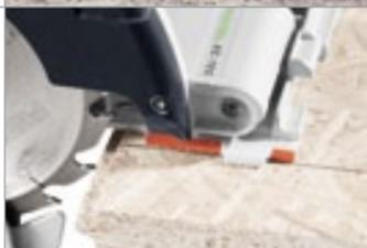
**Уникальное предложение: НК 85 с фрезером для выборки пазов.** Всего несколько приёмов и комплект переоснащения с переставляемой пазорезной головкой в виде опции – и вот уже из новой дисковой пилы НК 85 получается высокопроизводительный фрезер для выборки пазов. Идеально подходит для выборки продольных и поперечных пазов, например при фрезеровании подступенков и потолочных перекрытий, вставляемых в пазы.
