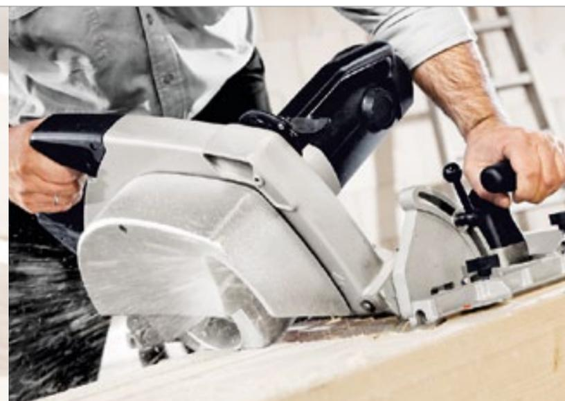
Снимаем пильный диск и ставим фрезу: с фрезой для выборки клиновидного паза дисковая пила НК 132 Е без особых усилий превращается в надёжный плотницкий фрезер.
