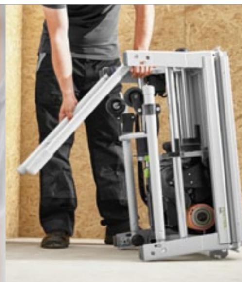
Универсальность – это просто. Быстрая установка CS 70 благодаря встроенным откидным ножкам. И быстрая переналадка с продольного реза на поперечный благодаря клиновидному пазу по периметру для установки углового упора.
