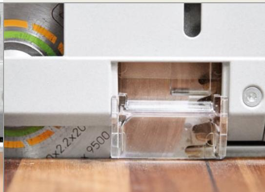
Высокоточные резы для сокращения доводочных работ: в зависимости от стоящей задачи, TSC 55 может оснащаться противоскольным вкладышем для пропилов без сколов с обеих сторон или смотровым окошком для хорошего обзора разметки.
